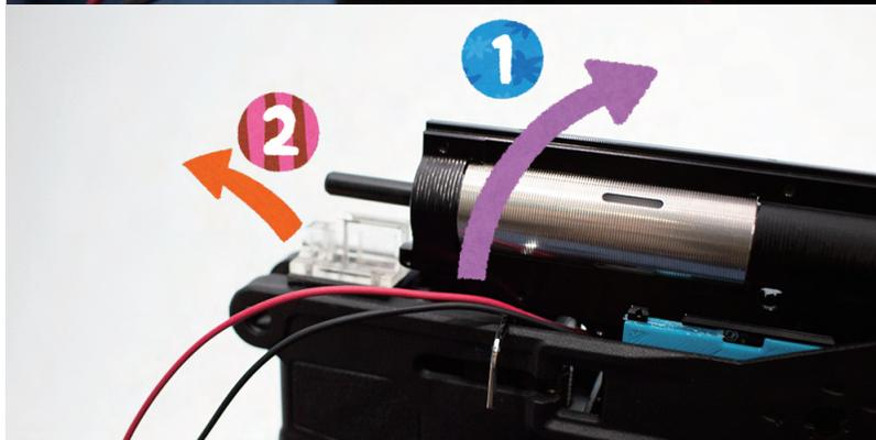
その後チャンバーベースを取り付けます。メカボックスが元の位置でも取り付け可能です。最後にビスで固定してください。
